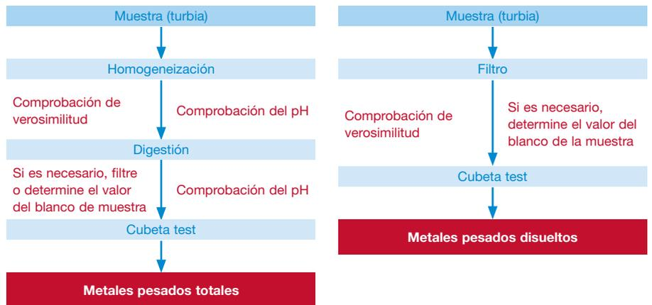
Fig. 2: Pasos de trabajo para determinar el contenido total de metales pesados y el contenido de metales pesados disueltos.
