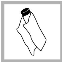
8. Utilice el paño lubricante suministrado para aplicar el aceite de forma uniforme por la superficie de la cubeta de muestras. Elimine el exceso de aceite. Asegúrese de que la cubeta de muestras esté casi seca.
