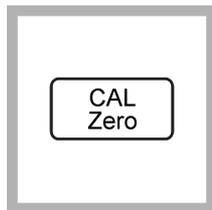
4. Pulse **CAL/Zero** (CAL/Cero). La luz CAL/Zero (CAL/Cero) se iluminará, y la pantalla de modo mostrará "00". Aparecerá el valor NTU del agua de dilución usada en la calibración anterior.
