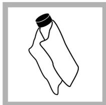
**4.** Utilice el paño lubricante suministrado para aplicar el aceite de forma uniforme por la superficie de la cubeta de muestras. Elimine el exceso de aceite. Asegúrese de que las cubetas de muestras estén casi secas.
