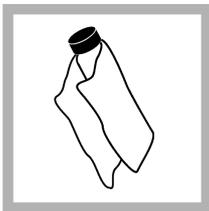
7. Utilice el paño lubricante para aplicar el aceite de forma uniforme por la superficie del vial. Elimine el exceso de aceite. Asegúrese de que el vial esté casi seco.
