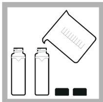
**1.** Enjuague dos o más cubetas de muestras vacías y limpias dos veces con agua de dilución y déjelas secar completamente. Rellene la cubeta de muestras hasta la línea (aprox. 30 ml) con agua de dilución filtrada y coloque inmediatamente el tapón de la cubeta de muestras. Consulte [Prepare agua de dilución](#) en la página 27.
