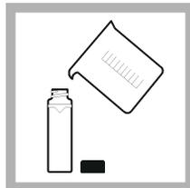
**1.** Enjuague una cubeta de muestras dos veces con la solución que se vaya a medir y déjela secar completamente. Llene la cubeta de muestras hasta la línea (aprox. 30 ml) con muestra y coloque inmediatamente el tapón de la cubeta de muestras.
