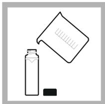
**1.** Enjuague una cubeta de muestras vacía y limpia dos veces con agua de dilución y déjela secar completamente. Rellene la cubeta de muestras hasta la línea (aprox. 30 ml) con agua de dilución y coloque inmediatamente el tapón de la cubeta de muestras. Consulte [Prepare agua de dilución](#) en la página 27.
