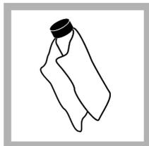
**4.** Utilice el paño lubricante suministrado para aplicar el aceite de forma uniforme por la superficie de la cubeta de muestras. Elimine el exceso de aceite. Asegúrese de que la cubeta de muestras esté casi seca.
